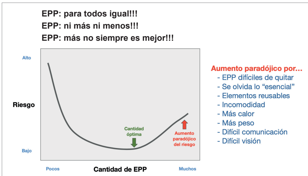
Figura 2. Uso suficiente y adecuado de equipos de protección personal (EPP)
