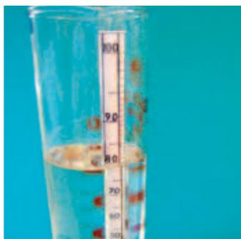
2. El análisis posterior a la elaboración es obligatorio cuando se utiliza etanol o una solución de isopropanol. Utilice el alcoholímetro para controlar la concentración de alcohol de la solución final. Los límites aceptables deberán quedar fijados en torno a  $\pm 5\%$  de la concentración deseada (75%–85% en el caso del etanol).
